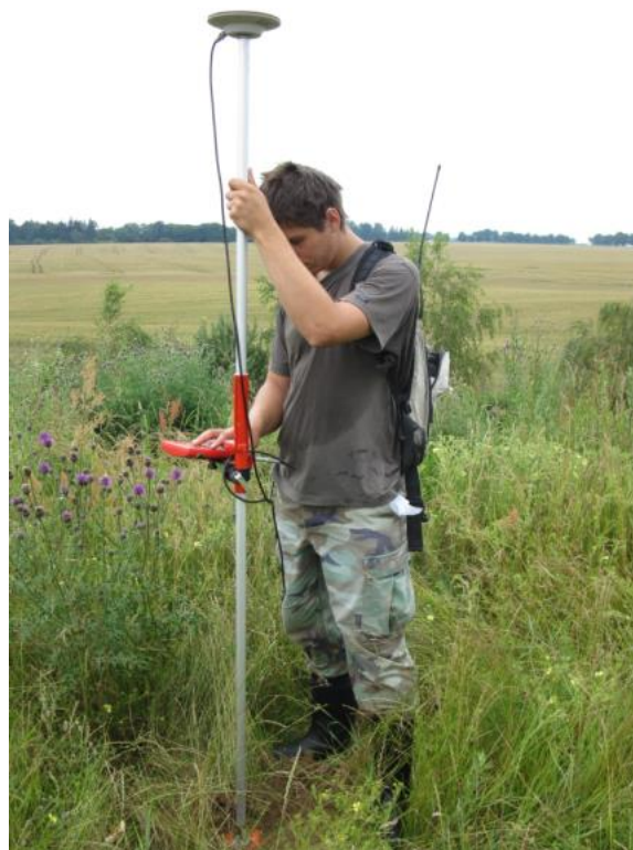
Fot. 5 Odbiornik "rover" - pomiar metodą statyczną (zdjęcie poglądowe)
