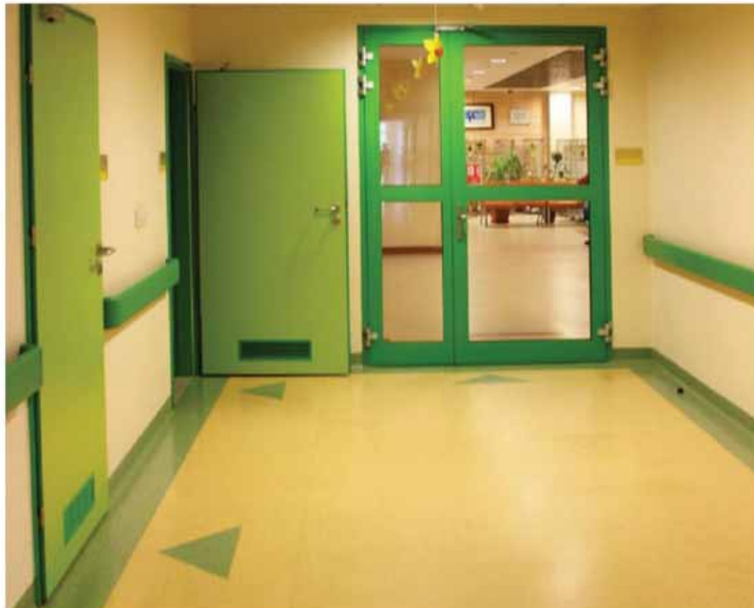
Rysunek 49. Przykład poprawnego stosowania kolorów i wzorów w przestrzeni korytarza. Widoczne są dodatkowe oznaczenia lokalizacji drzwi. [fot.: N. Ratajczak-Szponik].
